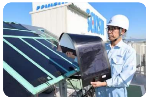
積水化学工業のペロブスカイト太陽電池 写真：日経電子版「曲がる太陽電池、官民協議会を設立 導入目標など策定へ」（2024年5月21日）
